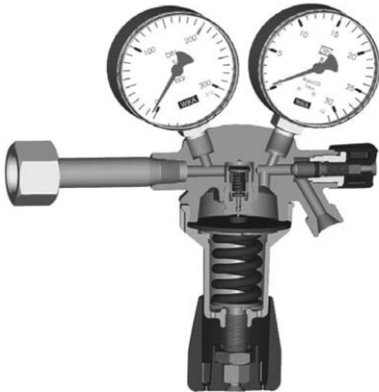
Abbildung 51: Druckminderventil zur Regulierung des Arbeitsdruckes [ST02]
