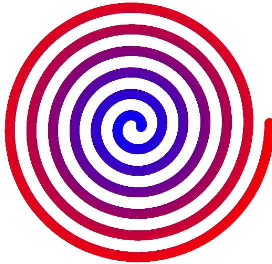
Abbildung 13 Schema Temperaturverlauf im Wärmeübertrager
